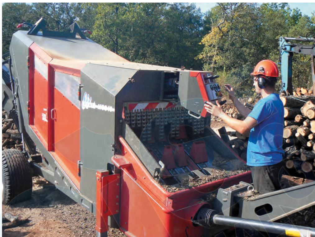
de coincement. La hauteur de coupe de ces scies est limitée à 245 mm de hauteur mais permet d'accepter des diamètres plus importants de 30 cm, voire plus.
