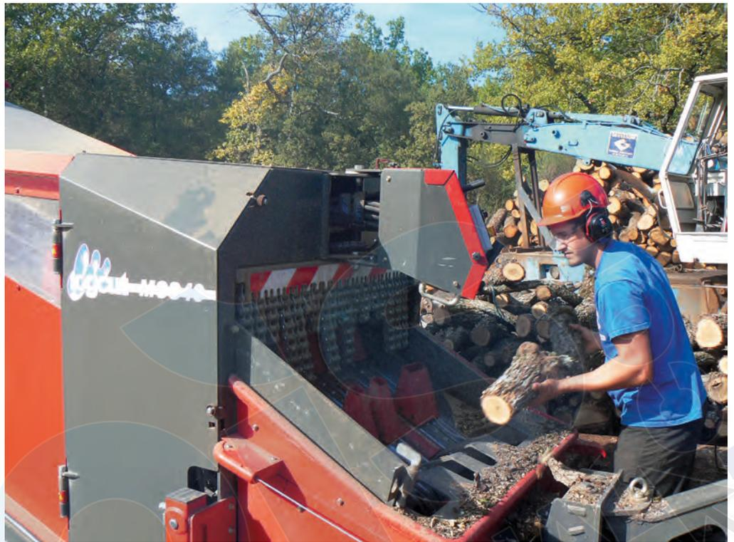
pour le groupe de travail (rouleaux de mise en référence, convoyeur, tapis d'évacuation) avec molette de réglage de la vitesse. Ces trois fonctions du groupe de travail peuvent permettre d'impulser des marches arrière en cas de blocage. De même, le convoyeur s'arrête systématiquement quand le tapis d'évacuation se bloque. Tout est donc regroupé sur le tableau de bord avec une utilisation très simplifiée. L'ensemble de la Logcut est en acier HLE avec des capots très
