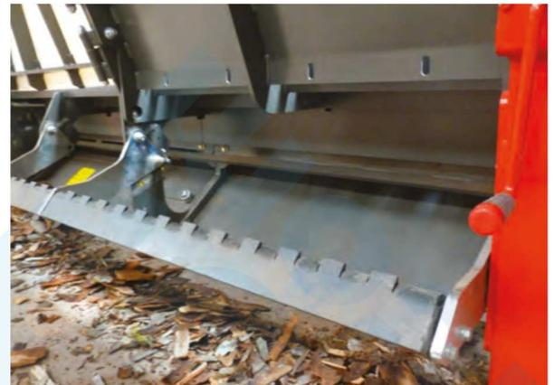
**Evacuation des écorces sur le côté du deck. Les machines Logcut découlent du besoin exprimé par des exploitants soucieux de produire du bois de cheminée de qualité, sec et prêt à l'emploi.**
